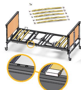
Montering av träribbor
